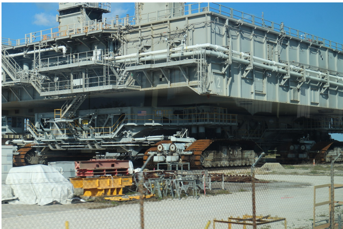
Figura 6 – o gigantesco crawler, veículo usado desde a era Apollo para transportar os foguetes do tipo Saturno V até as plataformas de lançamento. O mesmo veículo foi usado de 1980 até 2011 para transportar os ônibus espaciais completos, montados com os boosters sólidos montados até as plataformas de lançamento. Foto: Joseph Saab, 2017.
