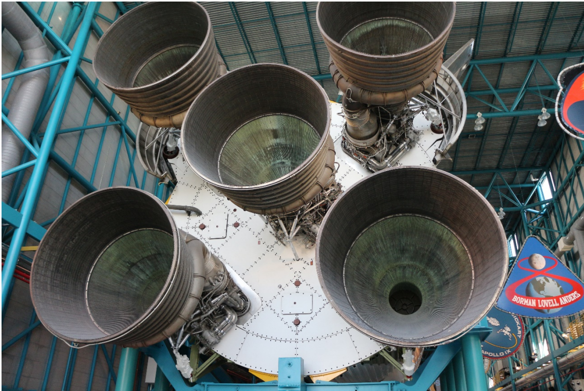
Figura 7 – Os 5 motores F1 do primeiro estágio (S 1) do Saturno V consumiam, em conjunto, 4.900 litros por segundo de combustível (RP-1) e 7.300 litros por segundo de oxigênio líquido! Foto: Joseph Saab, 2017.
