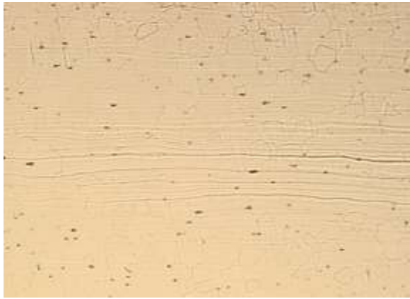
Figura 3. AISI 409 soldagem automática, ataque persulfato de amônia: a) região fora da solda, aumento 200 x; b) região solda, aumento 100x
