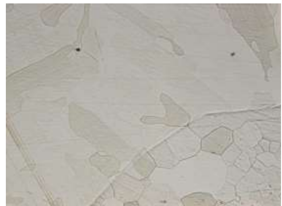
Figura 1. AISI 409 soldagem automática, ataque Vilela: a) região fora da solda, aumento 200 x; b) região solda, aumento 50x
