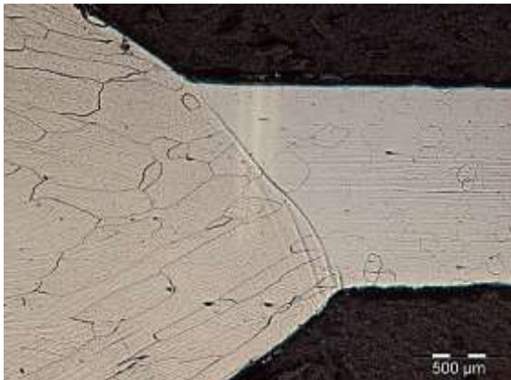
Figura 4. AISI 409 soldagem manual, ataque persulfato de amônia: a) região fora da solda 100 x; b) região solda 200 x; c) região de transição 100 x
