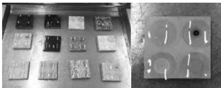
Figuras 1 e 2- Conjunto de amostras em teste; Amostra ampliada ( em cima- óleo e iodo; embaixo- ácido cítrico e hidróxido de potássio).
