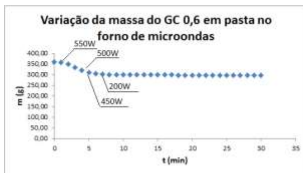
Figura 12 – curva da variação de massa em gramas no tempo para o GC 0,6 no forno de micro-ondas, indicando a potência absorvida pelo GC em alguns pontos.
