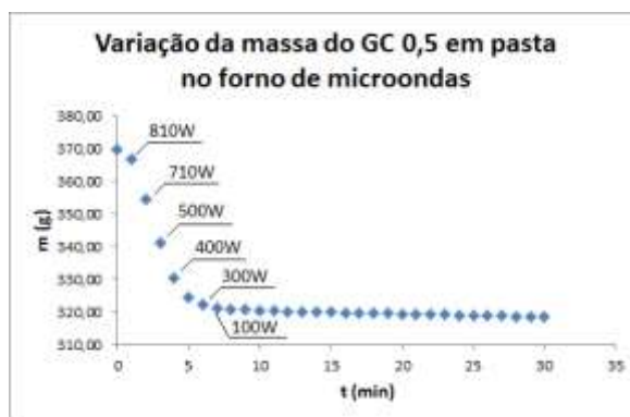
Figura 11 – curva da variação de massa em gramas no tempo para o GC 0,5 no forno de micro-ondas, indicando a potência absorvida pelo GC em alguns pontos.
