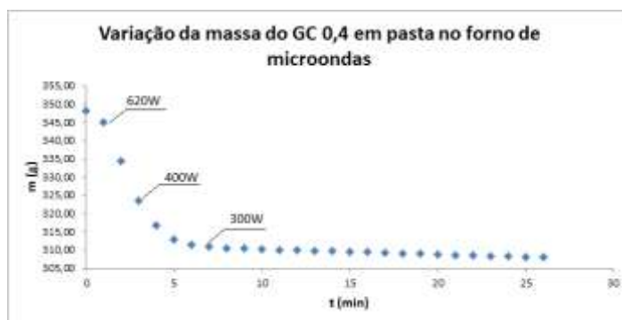
Figura 10 – curva da variação de massa em gramas no tempo para o GC 0,4 no forno de micro-ondas, indicando a potência absorvida pelo GC em alguns pontos.
