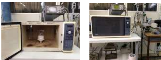
Figura 4 – Forno de micro-ondas utilizado. (Acima do forno localiza-se o visor que mostra as potências de “ida” e de “volta”. Abaixo do forno localiza-se a balança).
