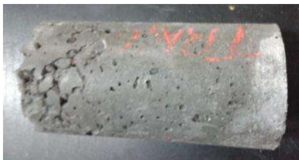
Figura 9 – Falha de adensamento na produção do corpo-de-prova do Traço 3.
