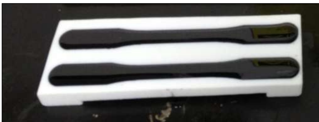
Figura 2: Corpos de prova de nano-compósito em molde de teflon.
