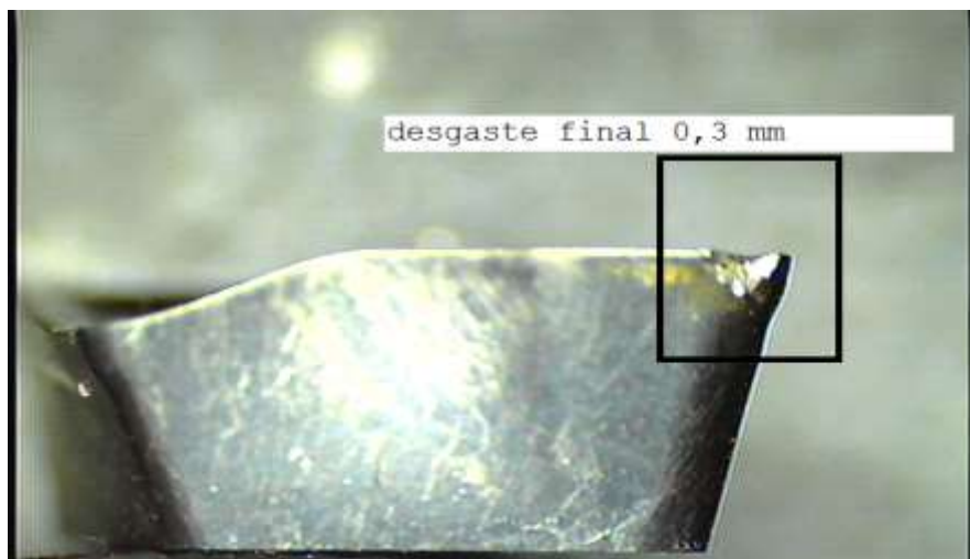
Figura 9 - Desgaste da pastilha 2 ao final do ensaio com usinagem com MQCL com ampliação de 60X.
