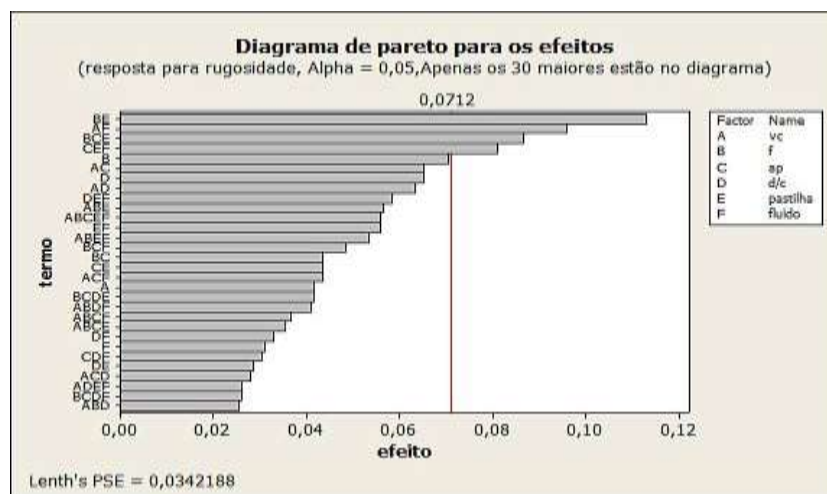
Figura 3 - Diagrama de Pareto das variáveis sobre a rugosidade para situação fluido em abundância x seco.
