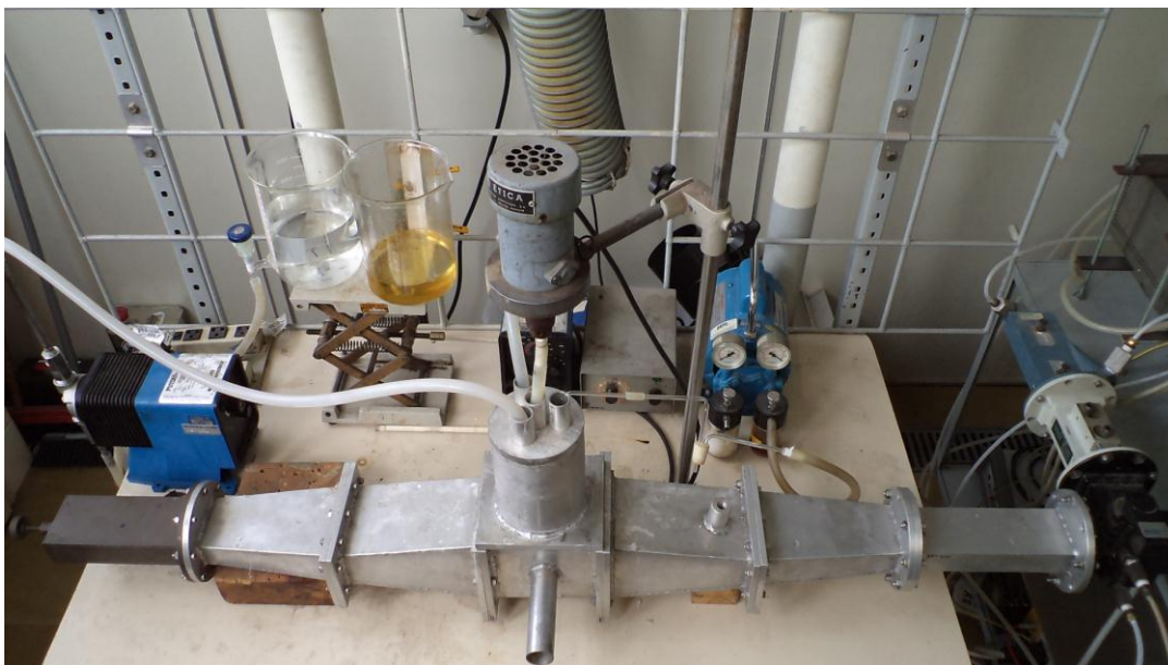
Figura 3: Vista do reator contínuo tipo tanque agitado irradiado por micro-ondas.
