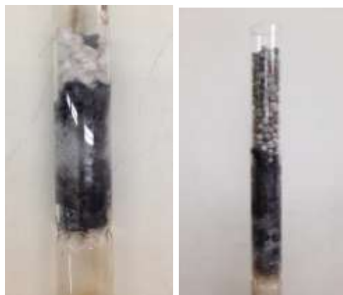
Figura 4 - Coqueificação da carga nas diferentes conformações de leito catalítico.
