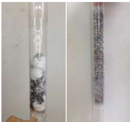
Figura 3 – Conformações de leito: zeólita particulada com tarugo de cerâmica (esquerda) e pelotas de zeólita e cerâmica (direita).
