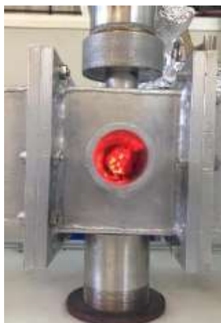
Figura 5 - Leito catalítico estratificado com pelotas de zeólitas e carbeto de silício incandescentes.
