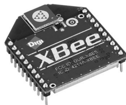
Figura 9 – Módulo Xbee com padrão IEEE 802.15.4
