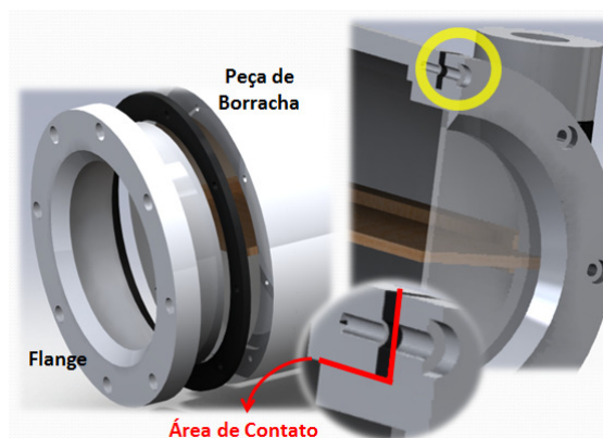
Figura 9 – Soluções para Estanqueidade Adotadas
