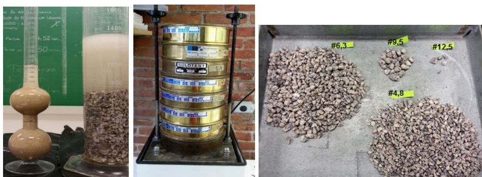
Figura 2: À esquerda tem-se o ensaio de massa específica da areia de rio e da brita 0, e, em seguida, o peneirador mecânico e a brita 0 submetida ao ensaio de peneiramento.
