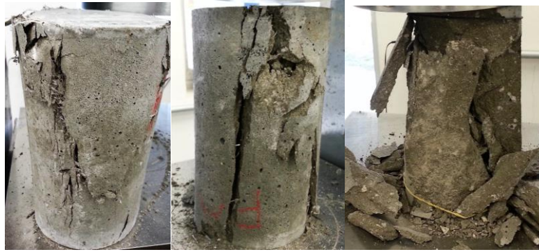
Figura 5: Em sequência têm-se a comparação da ruptura dos CP's de CRFP, CRFA e CS, submetidos ao ensaio de resistência à compressão.
