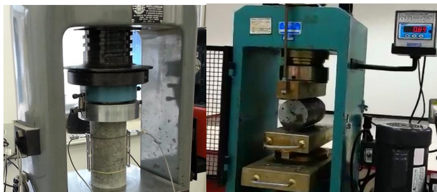
Figura 4: À esquerda, ensaio para determinar o módulo de elasticidade e resistência à compressão e, à direita, ensaio de resistência à tração por compressão diametral.
