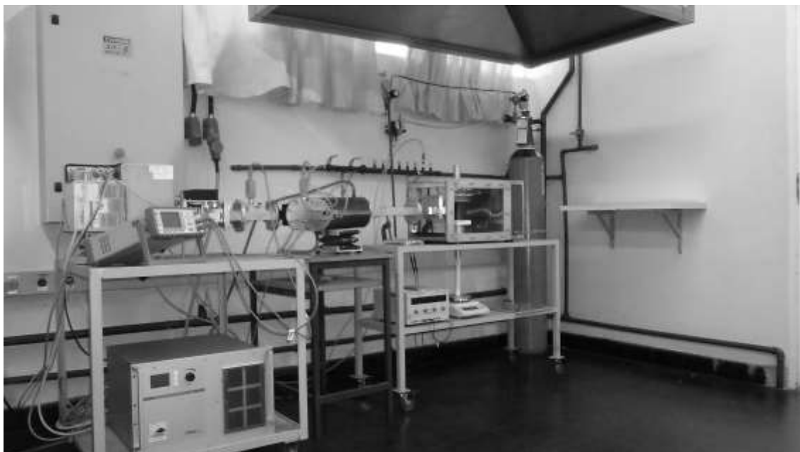
Figura 1 – Vista geral do forno paralelepípedo para redução carbotérmica de cromita por irradiação de micro-ondas
