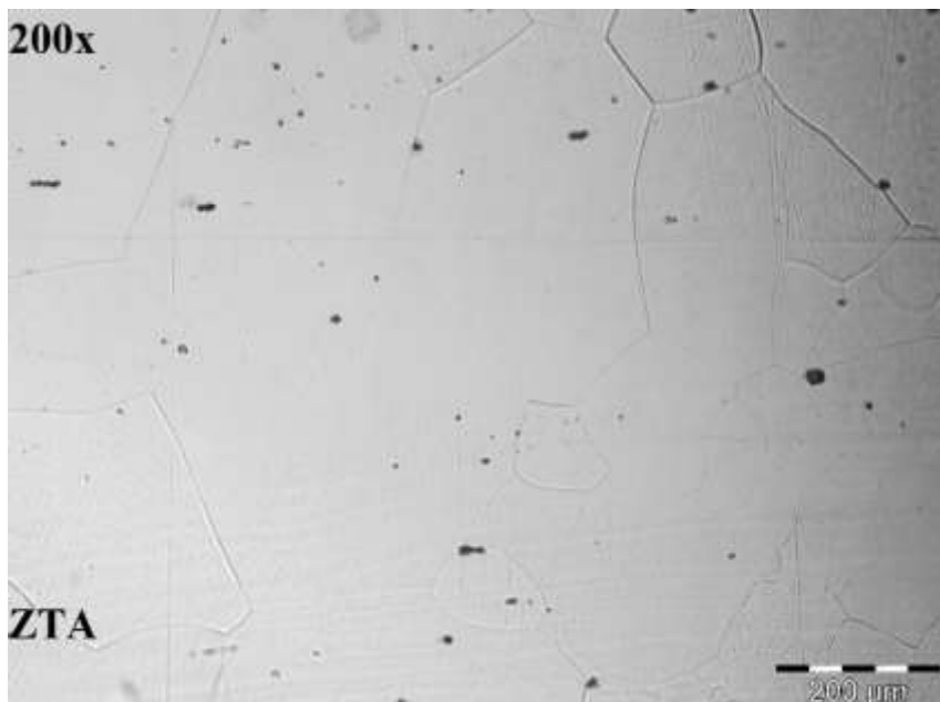
Figura 10 – Metalografia da ZTA do Aço Inox AISI 409. Ataque com Ácido Oxálico 10%. Aumento de 200x. Amostra 1(arame biestabilizado).
