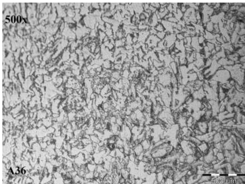
Figura 7 – Metalografia do metal base do Aço ASTM A36. Ataque com Nital 2%. Aumento de 500x. Amostra 1.
