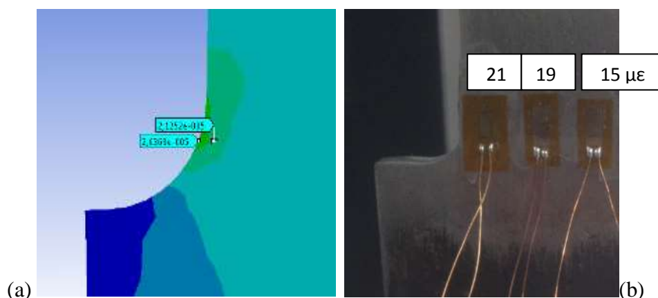
Figura 11 – (a) Resultados do teste numérico 1 de tração do corpo de prova 3. Resultados são expressos em valores absolutos de deformação. (b) Resultados do teste experimental 1 de tração do corpo de prova 3. Valores expressos em micro deformações \mu\epsilon .
