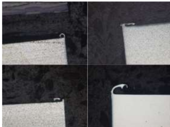
Figura 8 - Rebarbas das peças 17 e 24 (superiores) e 27 e 32 (inferiores). Imagens obtidas através de microscópio óptico.
