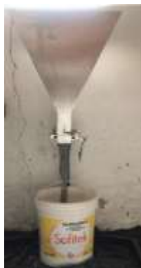
Figura 6 – Método do Funil V
