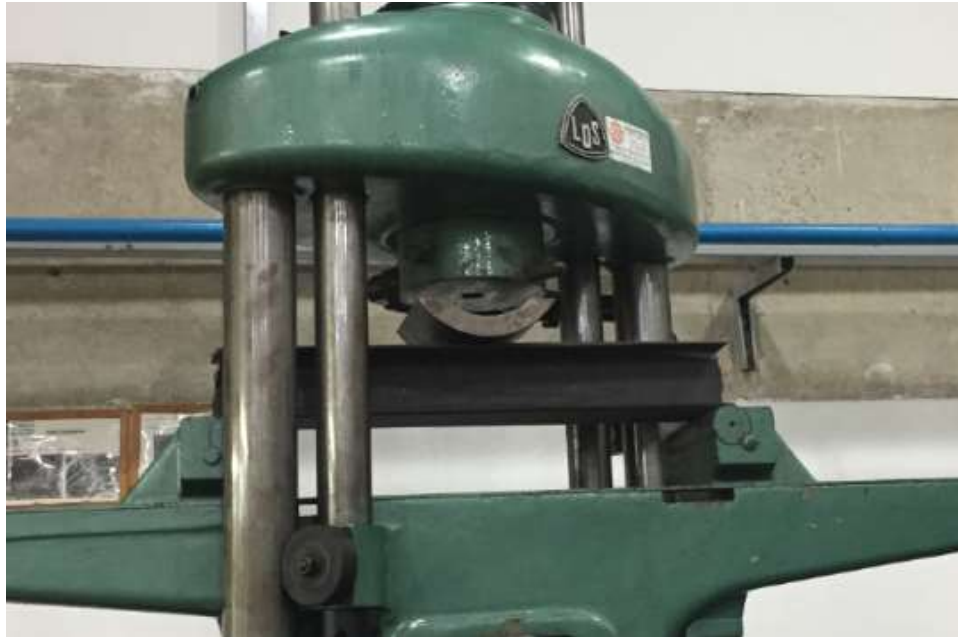
Figura 12- Ensaio de três pontos realizado em uma viga de carbono com seção I.
