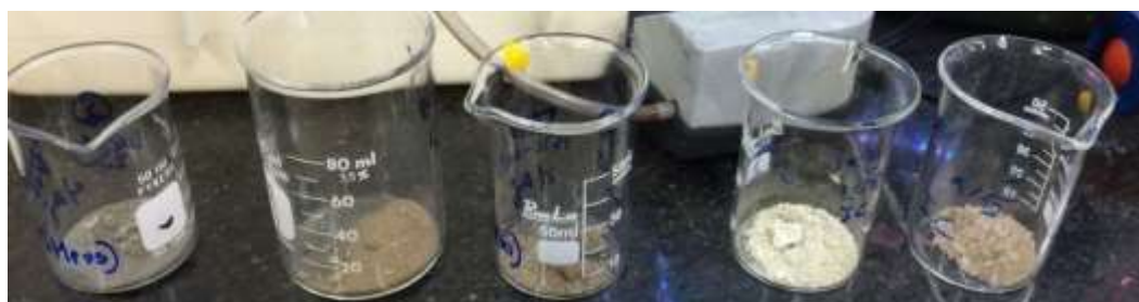
Figura 19: Resultados da deposição de prata metálica em cinco amostras de poli(divinilbenzeno)
