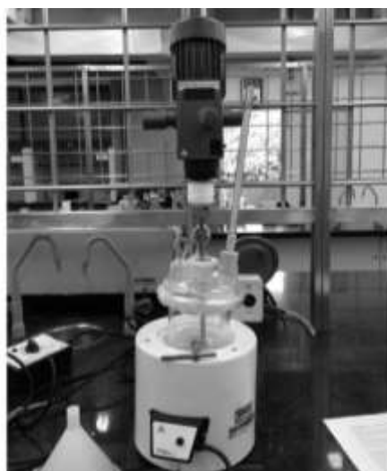
Figura 7: Equipamentos utilizados no processo de polimerização. Composto por um reator tipo kettle, uma manta térmica, um termômetro analógico e um agitador mecânico.
