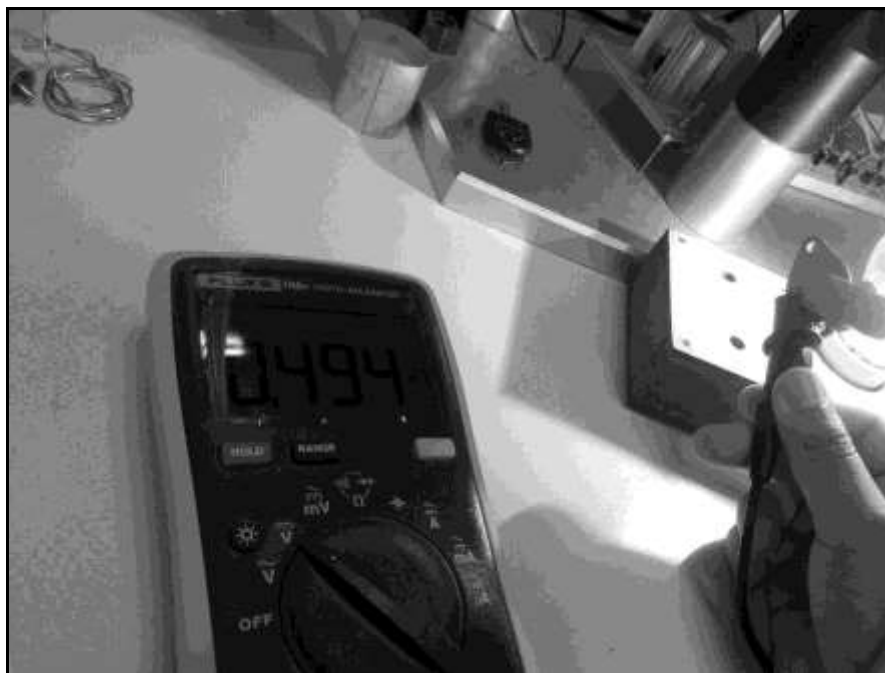
Figura 6 – Teste do 2N3055 utilizando uma lâmpada incandescente de 30W.
