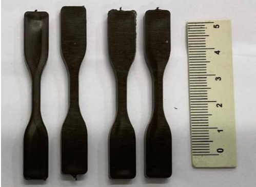
Figura 2 – Corpo de prova de tração de uma amostra dosada com 1,0% de nanocobre
