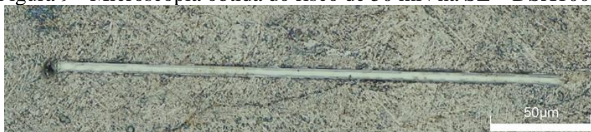
Figura 9 - Microscopia obtida do risco de 50 mN na SL – DSX1000.
