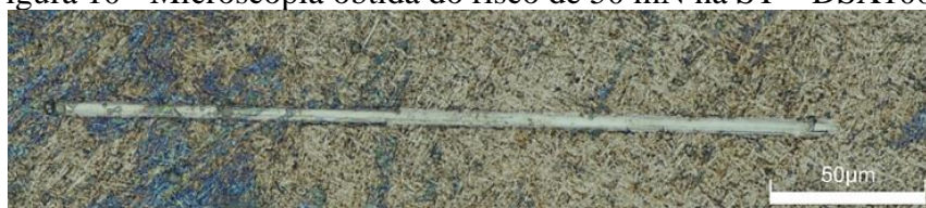
Figura 10 - Microscopia obtida do risco de 50 mN na ST – DSX1000.
